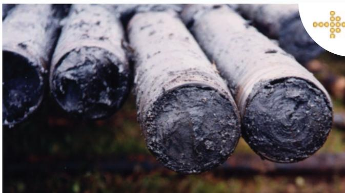
Tubería de Producción totalmente obstruida por depósitos de compuestos pesados del crudo
